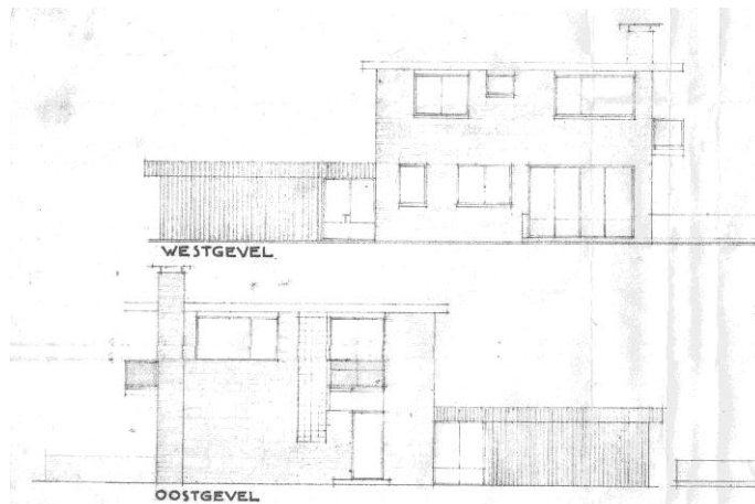
Uitsnede uit bestektekening 1933 – de garage nog in gegolfd plaatstaal
